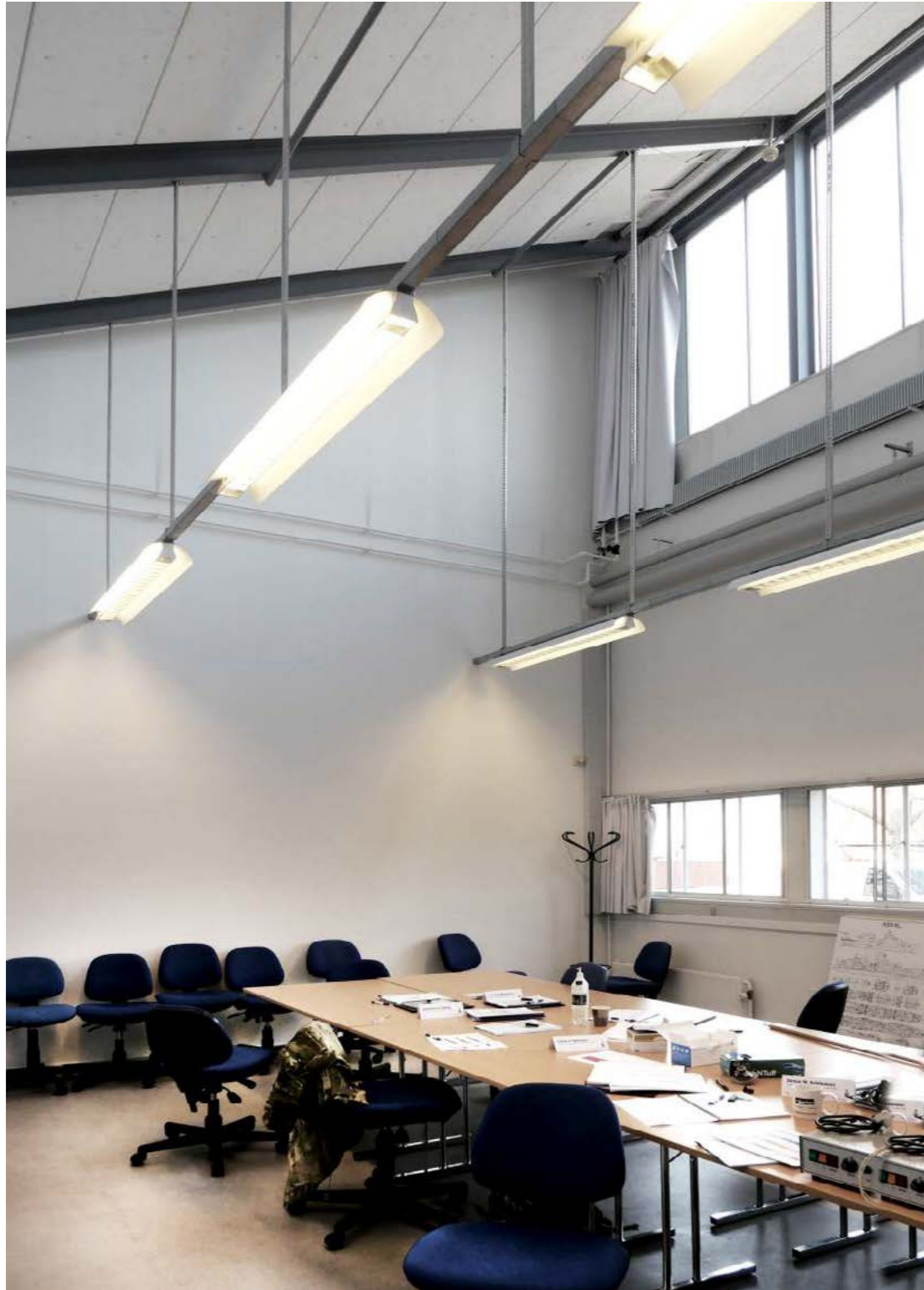
8 Mod nord i Torpedoværkstedet opstår en særlig rumlighed. På grund af shedtagkonstruktion lodrette vinduer bliver rummene dobbelthøje, hvilket vinduernes placering i henholdsvis facadens tavl og tagets lodrette konstruktion understreger.
